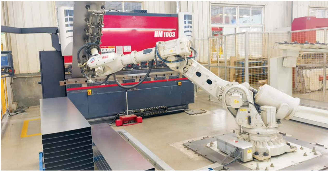
山东富士制御电梯有限公司直梯生产车间自动折弯机器人正在作业。 谢卫振 摄
