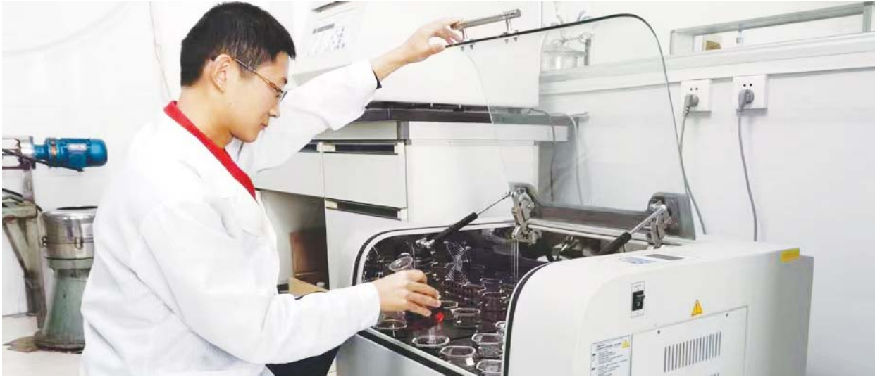
禹城是科技创新沃土。图为山东福田药业有限公司采用恒温振荡培养箱进行微生物菌种小试试验培养。
