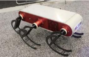
近日，美国麦吉尔大学和宾夕法尼亚大学合作设计出一款具有鳍状足的机器人，能在陆地和水中移动。机器人已经通过36.5米的深度测试，可以自动操作或通过光学系统遥控操作。
