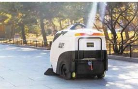
近日在北京亮相的无人智能清扫车“蜗小白”，采用了智能AI技术和无人驾驶技术，集成了多源传感器感知、融合定位、智能决策等技术，成为可以自动完成清扫、洒水、智能避障的“超级清洁工”。
